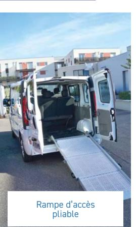
Entièrement manuel, le pliage et le dépliage de la rampe est assisté mécaniquement pour faciliter sa manipulation. Grâce à des fixations de sécurité sur le plancher, le montage et le démontage sont rapide et facile. Pour transporter une personne dans son fauteuil roulant à l'arrière du véhicule, il est obligatoire d'additionner à la rampe un système d'arrimage du fauteuil roulant et une poignée d'ouverture d'urgence.
