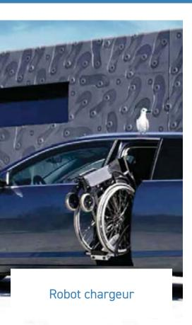
La porte arrière coulissante avec son robot chargeur permettent de monter automatiquement le fauteuil roulant derrière le siège conducteur, tout en préservant une partie de la banquette arrière. Ce système est activé grâce à un interrupteur ou une télécommande placé sur le tableau de bord.
